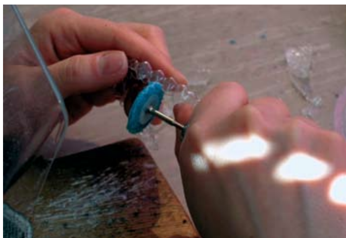
Ryc. 7. Obróbka mechaniczna wytłoczonego materiału za pomocą specjalnie utworzonego zestawu narzędzi do obróbki folii termoformowalnych firmy Scheu Dental
