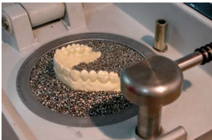
Ryc. 5. Model umieszczony w urządzeniu MINISTAR. Zawężenie pola operacyjnego odbywa się za pomocą granulatu; działanie to ułatwia dalsze czynności
