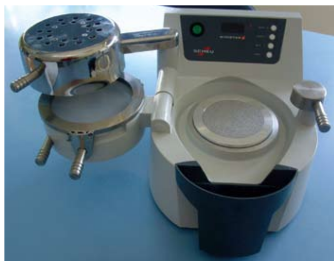
Ryc. 2. Nowa wersja urządzenia MINISTAR S z elektronicznym panelem sterującym, timerem i szybko nagrzewającą się grzałką
